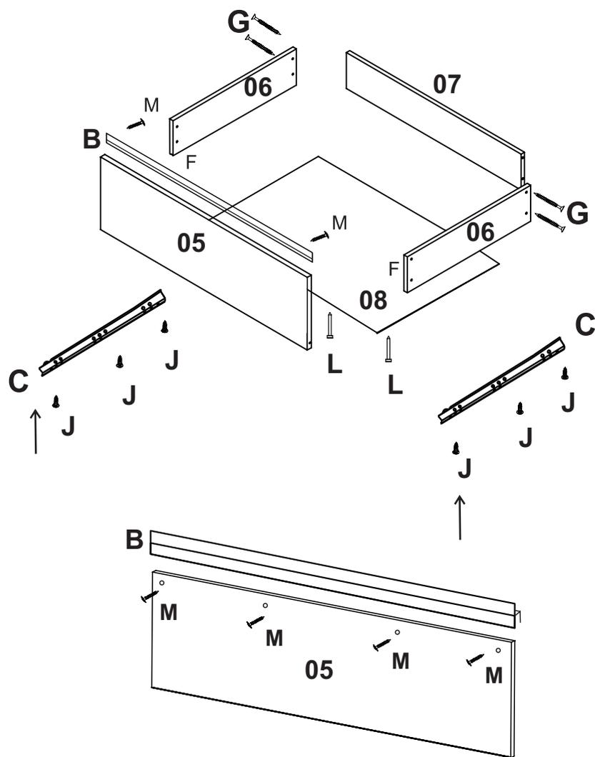
Observação: Na fixação dos puxadores, utilizar parafuso 3,5x12FL verificar a altura do encaixe do puxador na gaveta e com uma parafusadeira ou chave philips rosquear o parafuso diretamente no puxador já encaixando na gaveta.
